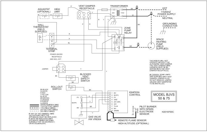
Figure 9a. Wiring Diagram, Spark Ignition System (BJVS 50 & 75).
